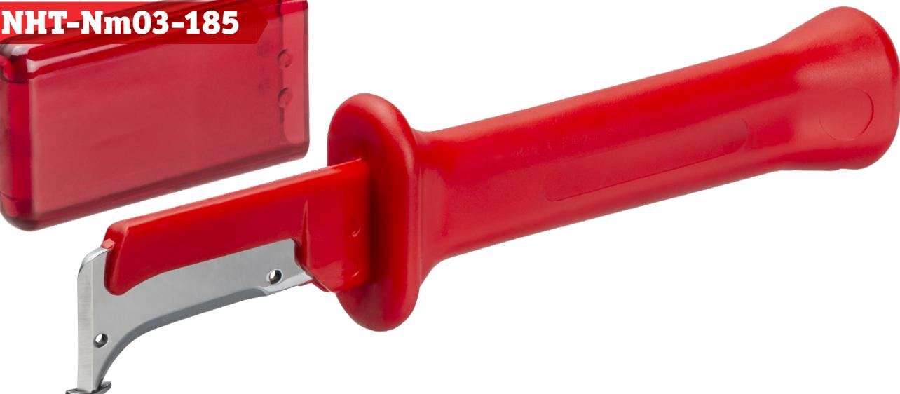
**Монтерский нож NHT-Nm03-185** предназначен для снятия оболочки и изоляции с проводов и кабеля, зачистки жил от окисной пленки малого и среднего сечения, поперечной и продольной резки изоляции. Зеркально отполированная войлоком и пастой ГОИ «пятка» с двумя осями симметрии имеет низкий коэффициент трения, обеспечивает быструю, комфортную работу и надежно защищает внутренние жилы от повреждения.
