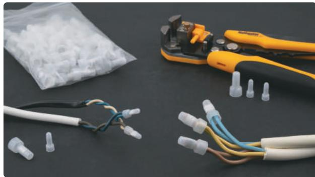
**Концевые изолированные заглушки (КИЗ) Navigator серии NWJ** предназначены для соединения и изоляции концов жил медных проводов методом опрессовки. Заглушка надевается на пучок защищенных проводов и обжимается специальными пресс-клещами. Конструкция изделия не предусматривает повторного использования. Заглушки предназначены для работ в электрических цепях напряжением до 690 В.
