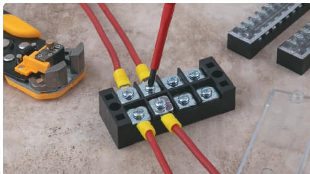
**Клеммные терминалы Navigator серии NTB-TB** предназначены для винтового соединения и ответвления медных проводников в электрических цепях напряжением до 600 В. Устанавливаются на монтажную панель через специальные отверстия в корпусе.
