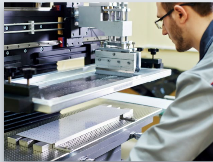
Линии поверхностного монтажа для производства светодиодных модулей
