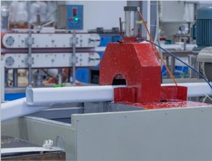
Производство пластиковых деталей по технологиям экструзии и литья под давлением
