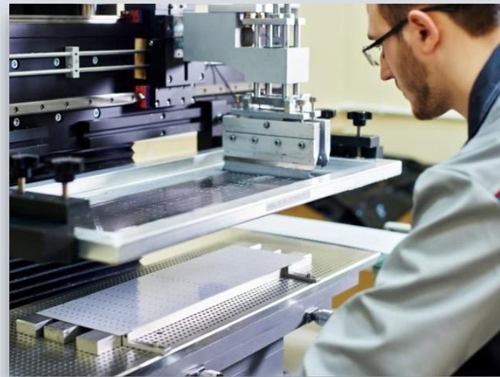
Линии поверхностного монтажа для производства светодиодных модулей
